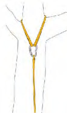
Fig. 5 - Ancoraggio della fune con dispositivo passante
