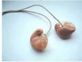
Figura 5. Monitor intraauricolari personalizzati (Fonte: Linee guida europee [1]).
