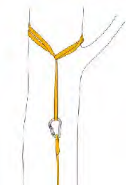
Fig. 4 - Ancoraggio della fune con dispositivo a strozzo mediante anello di fettuccia
